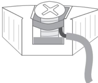
Провод монтируют между пластинами
